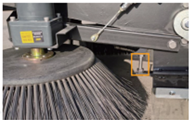
Einstellschraube für die hintere Seitenbürste
