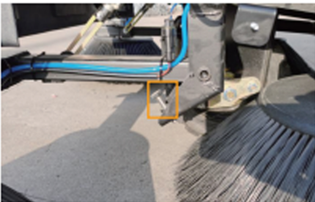
Einstellschraube für die vordere Seitenbürste
